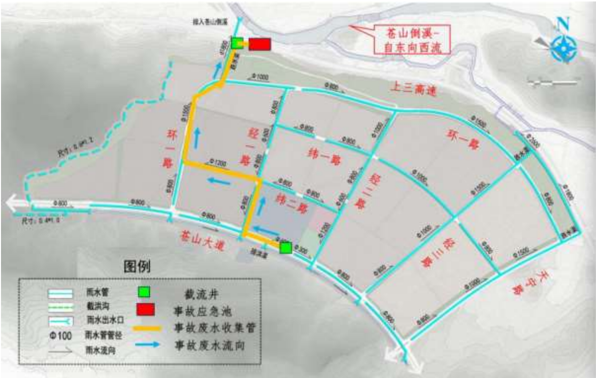
图 7.2.8-1 苍山化工园区事故应急池及截流井位置示意图
