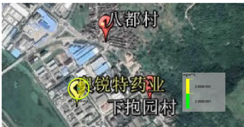
图 6.3.5-3 氢氟酸储罐泄漏影响预测图
